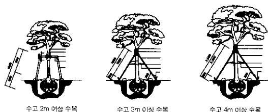
그림 7 수고별 지주목 설치 상세도
