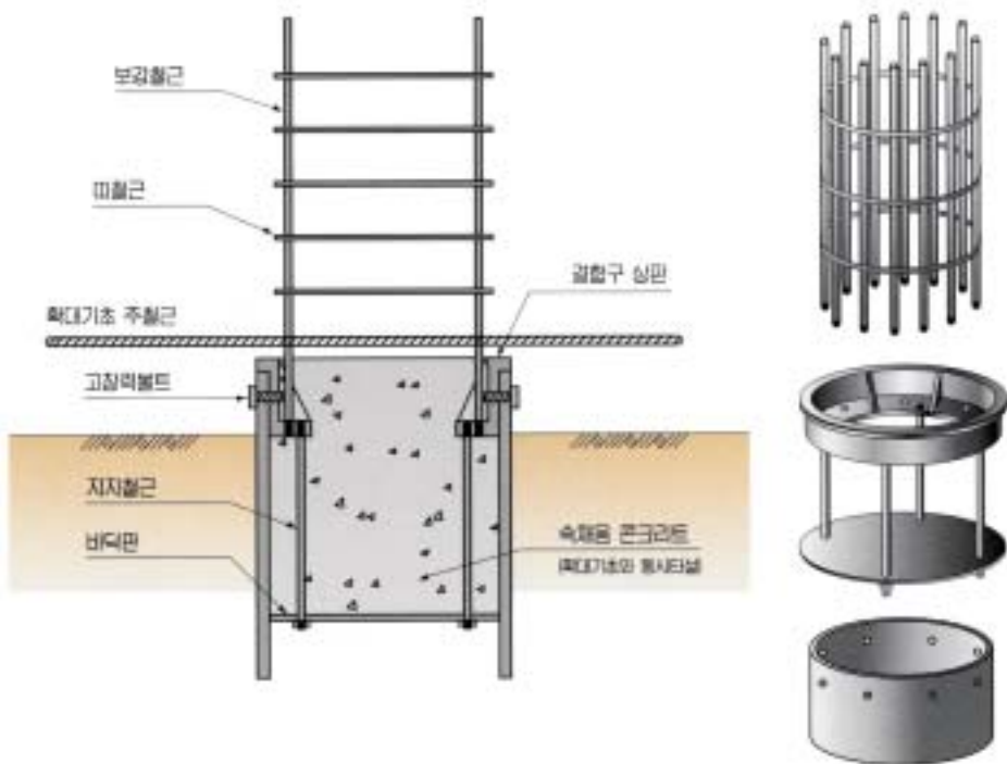
<그림 2-1> 강관말뚝 합성형 두부보강공법 개요도
