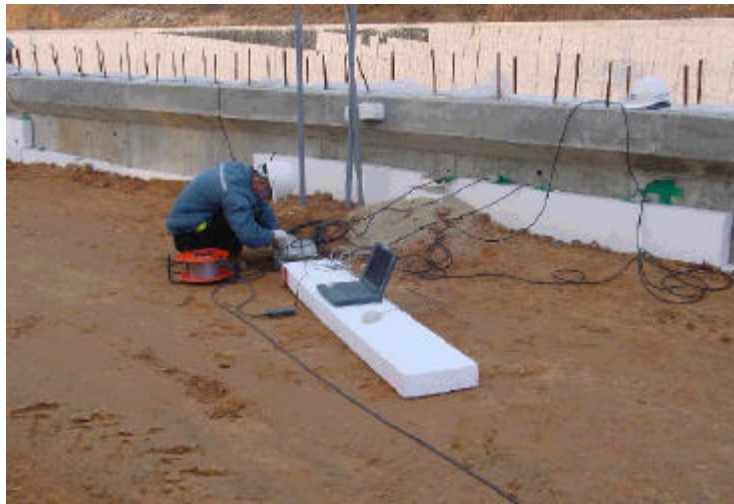
<그림 3-2> EPS 용벽 설치 후 거동분석을 위한 계측
