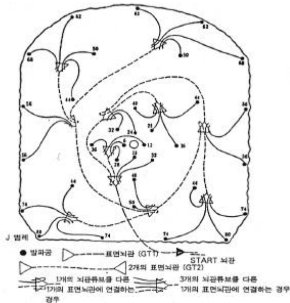
<그림 6-1> 터널에서의 비전기식 뇌관 패턴 예
