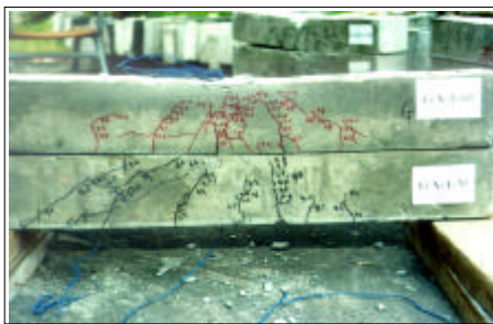
<그림 2-11> 현장철근을 이용한 시험체의 파괴모습
