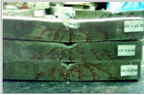
<그림 2-13> 부식철근과 녹색거철근 <그림 2-14> 슬립시험체의 파괴모습 의 파괴모습 ( f_{ck}=430\text{kg/cm}^2 ) ( f_{ck}=240\text{kg/cm}^2 )
