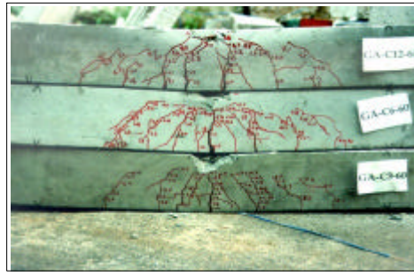
<그림 2-13> 부식철근과 녹색거철근 <그림 2-14> 슬립시험체의 파괴모습 의 파괴모습 ( f_{ck}=430\text{kg/cm}^2 ) ( f_{ck}=240\text{kg/cm}^2 )
